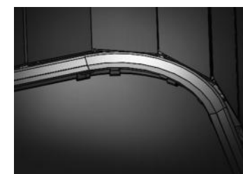
转角地轨榫卯式连接, 运行平滑稳定。
